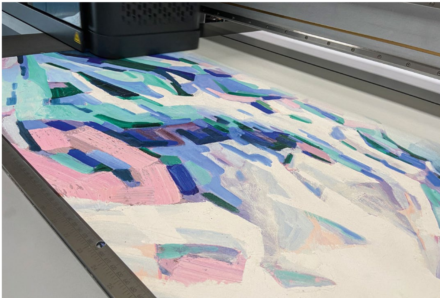
LED-UV-Druckanlage beim Drucken eines Replikates auf Alu-Verbundmaterial oder Kunstleinen.
