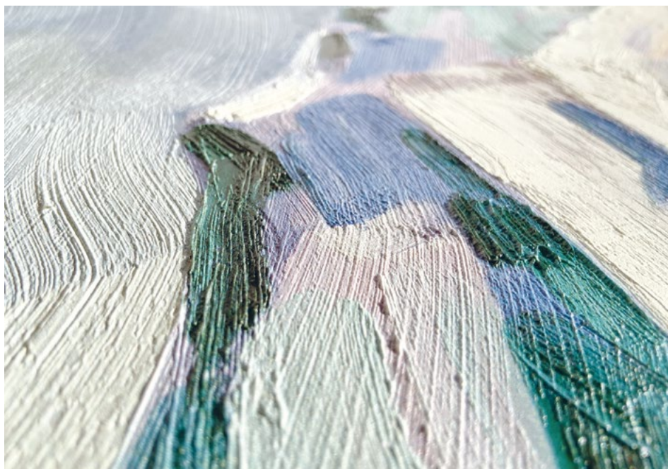
Vergrößertes Detail eines gedruckten Replikates mit Struktur. Man erkennt gut alle Erhebungen und Vertiefungen, welche originalgerecht gedruckt werden.
